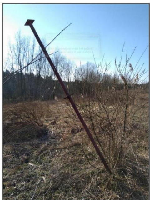
Zakbaken 8: Niet gevonden op positie zoals aangegeven op verstrekte tekening. Deze was dusdanig gedeformeerd/verstoord dat hoogtemeting niet mogelijk was. Er was een verlengstuk gemonteerd
