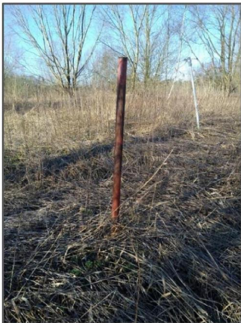
Zakbaken 6: Niet gevonden op positie zoals aangegeven op verstrekte tekening. Deze was dusdanig gedeformeerd/verstoord dat hoogtemeting niet mogelijk was. Flens van verlengstuk was volledig verdwenen.
