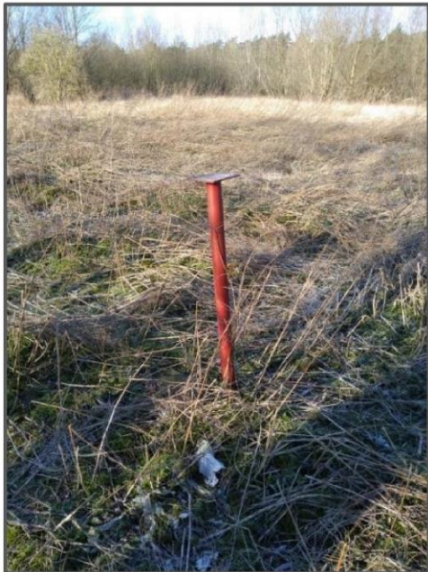
Zakbaken 5: Niet gevonden op positie zoals aangegeven op verstrekte tekening. Zakbaken was in goede staat.
