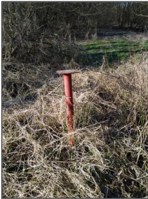
Zakbaken 9: Niet gevonden op positie zoals aangegeven op verstrekte tekening. Zakbaken was in goede staat.
