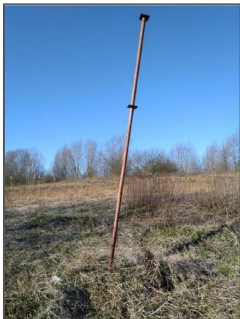
Zakbaken 7: Niet gevonden op positie zoals aangegeven op verstrekte tekening. Deze was dusdanig gedeformeerd/verstoord dat hoogtemeting niet mogelijk was. Er was een verlengstuk gemonteerd.
