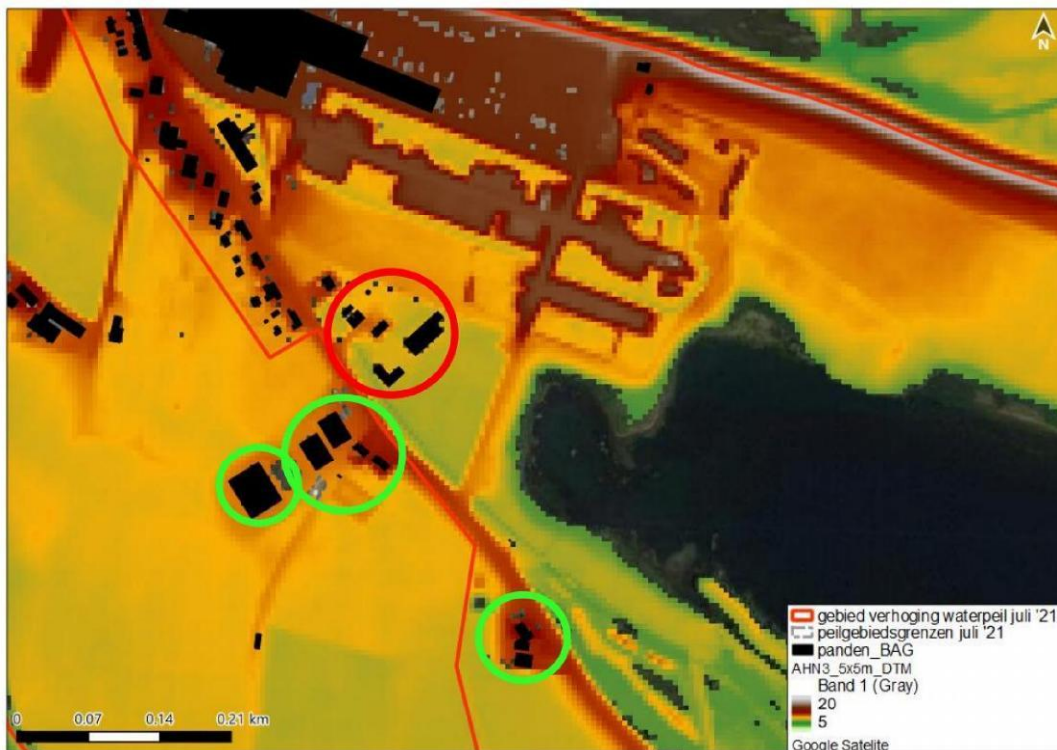
Afbeelding 8.34 Nadere detaillering van het maaiveld rondom deze de panden met verhoging van de grondwaterstanden. De meeste panden (groene cirkels) liggen verhoogd in het maaiveld waardoor het risico op grondoverlast minder is. De rode cirkel bij panden die laag liggen in het maaiveld
