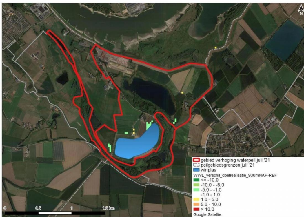
Afbeelding 6.31 Verandering in landbouwopbrengst derving in procentpunten door scenario NAP +9,30 m (rood (+) is afname van de doelrealisatie en groen (-) is een toename van de doelrealisatie)
