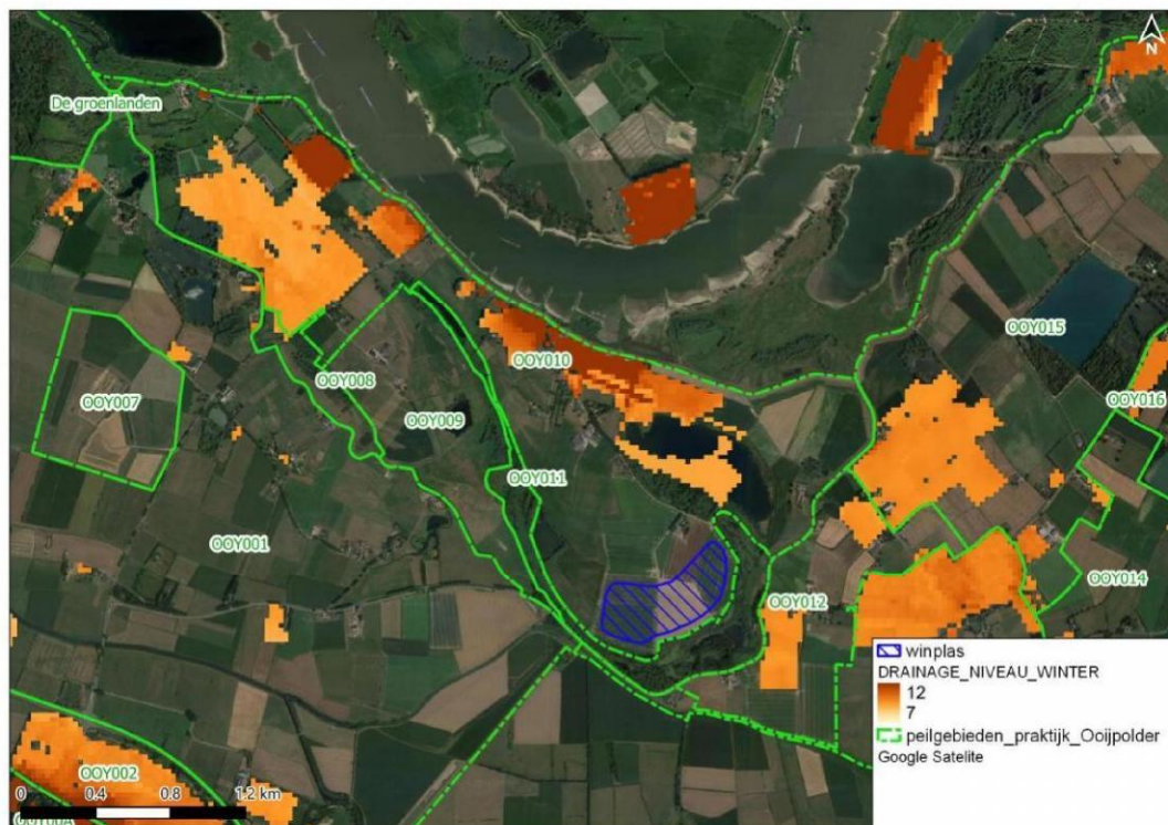
Afbeelding 4.12 DRN-cellen in het MORIA-grondwatermodel
