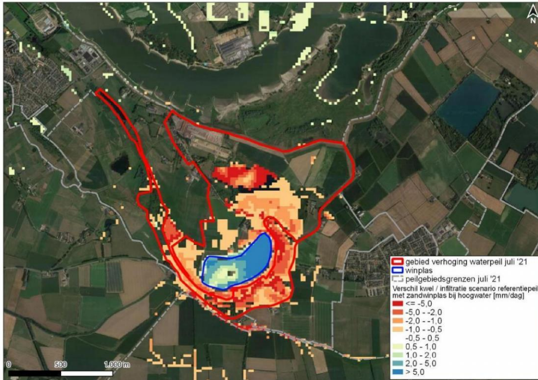
Afbeelding 5.23 Verandering in berekende kwelflux (rood=afname kwel of toename infiltratie, blauw=toename kwel of afname infiltratie) in het MORIA-model tijdens de hoogwater situatie door het scenario referentiepeil met winplas
