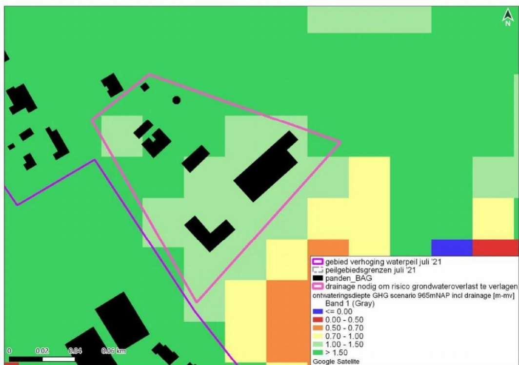
Afbeelding 8.36 Ontwateringsdiepte (maaiveld minus freatische grondwaterstand) bij GHG-situatie in het scenario met peilverhoging tot NAP +9,65m en het toepassen van drainage rondom de panden
