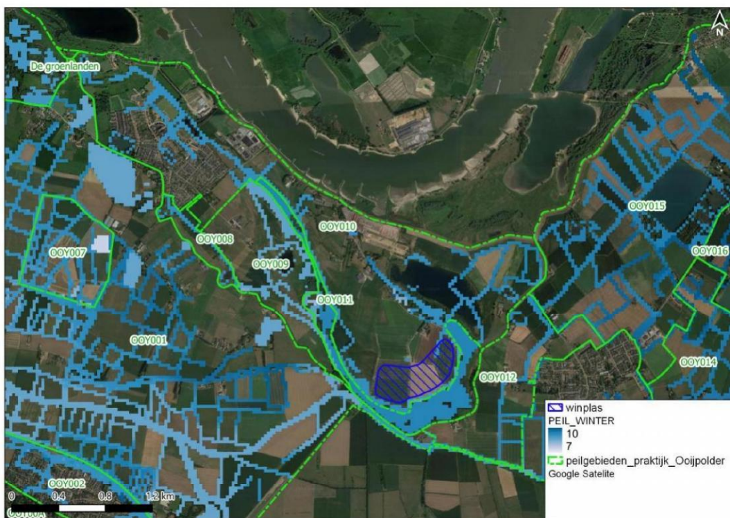
Afbeelding 4.11 RIV-cellen in het MORIA-grondwatermodel
