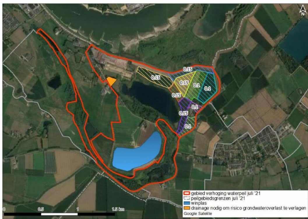
Afbeelding 8.35 Optimalisatie locaties (gearceerde landbouw percelen met daarin hoeveel meter verhoging nodig is om de grondwaterstandsstijging van de GHG te compenseren)
