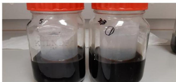
Afbeelding B3.2 Tweede incubatieproef met 300 ml mengsel van mineralenconcentraat en ammoniumsulfaatoplossing en 300 ml zinkacetaatoplossing.
