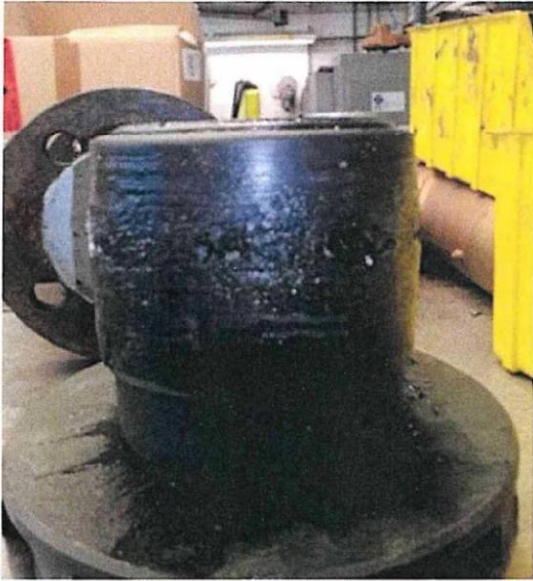
Figuur 6 – Beschadigde cup van de magneet
