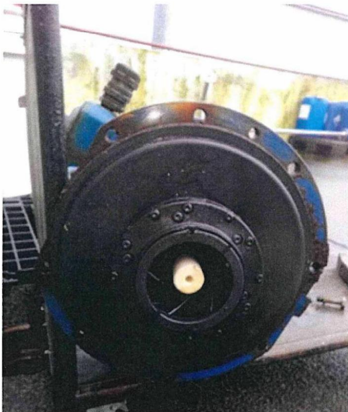
Figuur 5 - Waaier scheef op as
