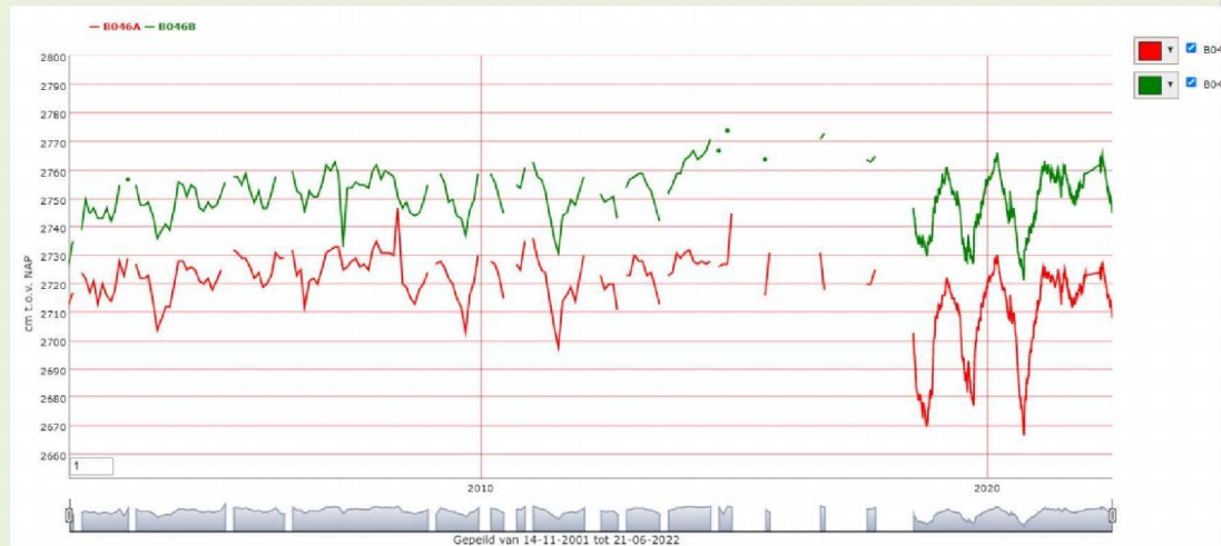
Figuur 2: Peilverloop in het Vragenderveen bij meetpunt B046A (filter in zandlaag onder het veen) en B046B (ondiepe filter in het veen); bron: Waterweb
