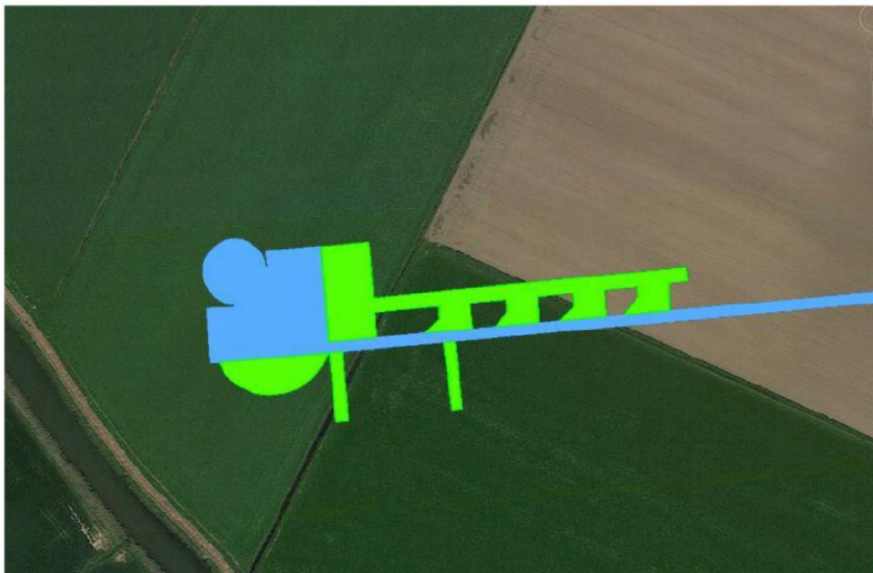
Afbeelding 2.5 Tijdelijke (groen) en permanente (blauw) verharding turbine 1.
