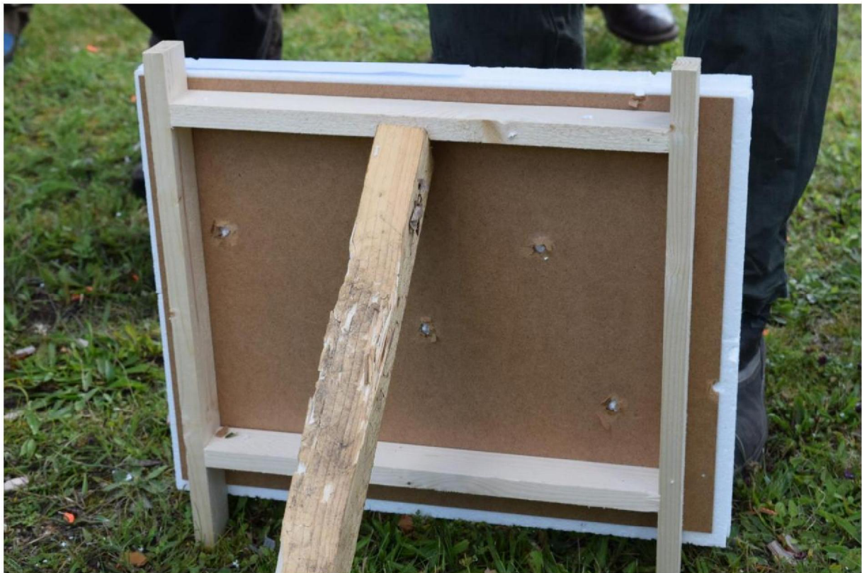
Abb. 2 Zielscheibe – Rückansicht auf 10 Meter nach dem 1. Durchgang mit RUBBER BUCKSHOT Kal. 12/67,5
