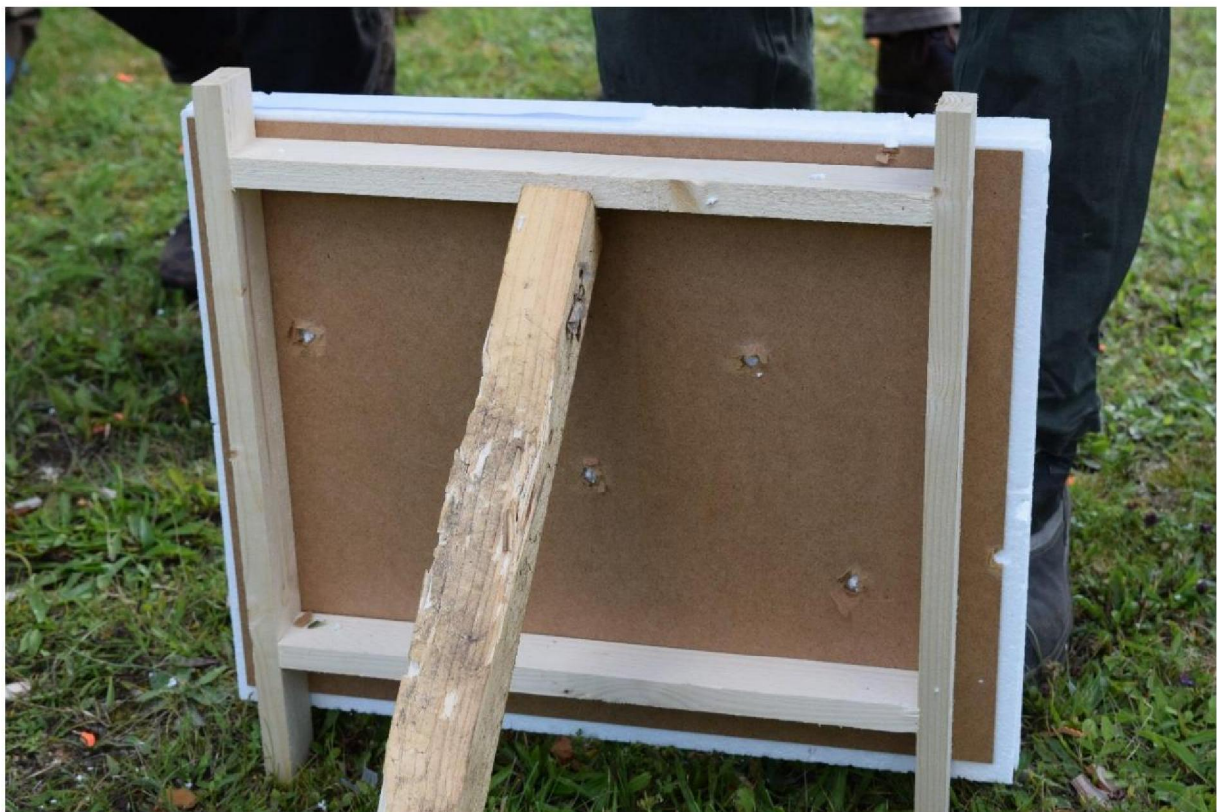
Abb. 15.2 RUBBER BUCKSHOT im 1. Durchgang; 6 der 10 Treffer als Durchschuss auf der Scheibe
