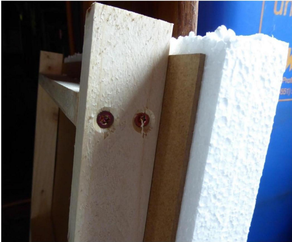
Abb. 3 Zielscheibe – Aufbau in der Seitenansicht (Querschnitt) besteht aus 4 cm dicken Styroporplatten, einer 6 mm dicken Hartfaserplatte und einem Holzrahmen zum Aufstellen
