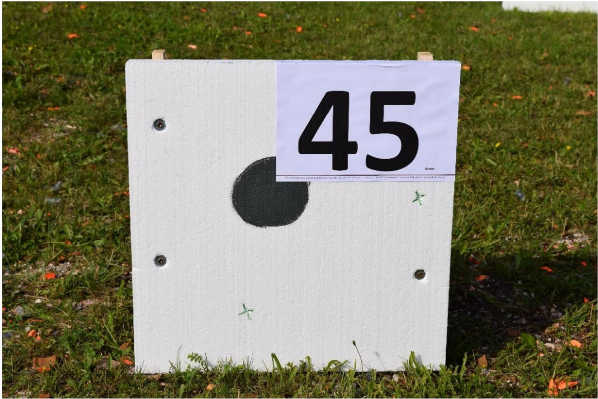
Abb. 15.9 RUBBER BUCKSHOT im 1. Durchgang; 2 Treffer von 15 auf der Scheibe, Gummischrot prallte ab und verursachte nur sehr leichte Eintiefungen im Styropor
