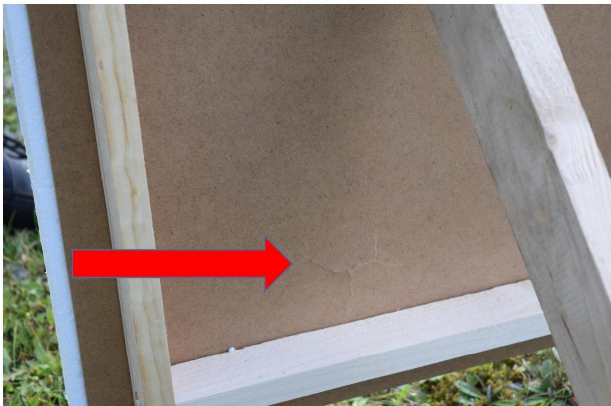
Abb. 16.4 RUBBER BATON Geschoss bleibt Versuchsaufbau auf 20 Meter Entfernung stecken und verursacht einen geringen Schaden an der Hartfaserplatte (Rückansicht)
