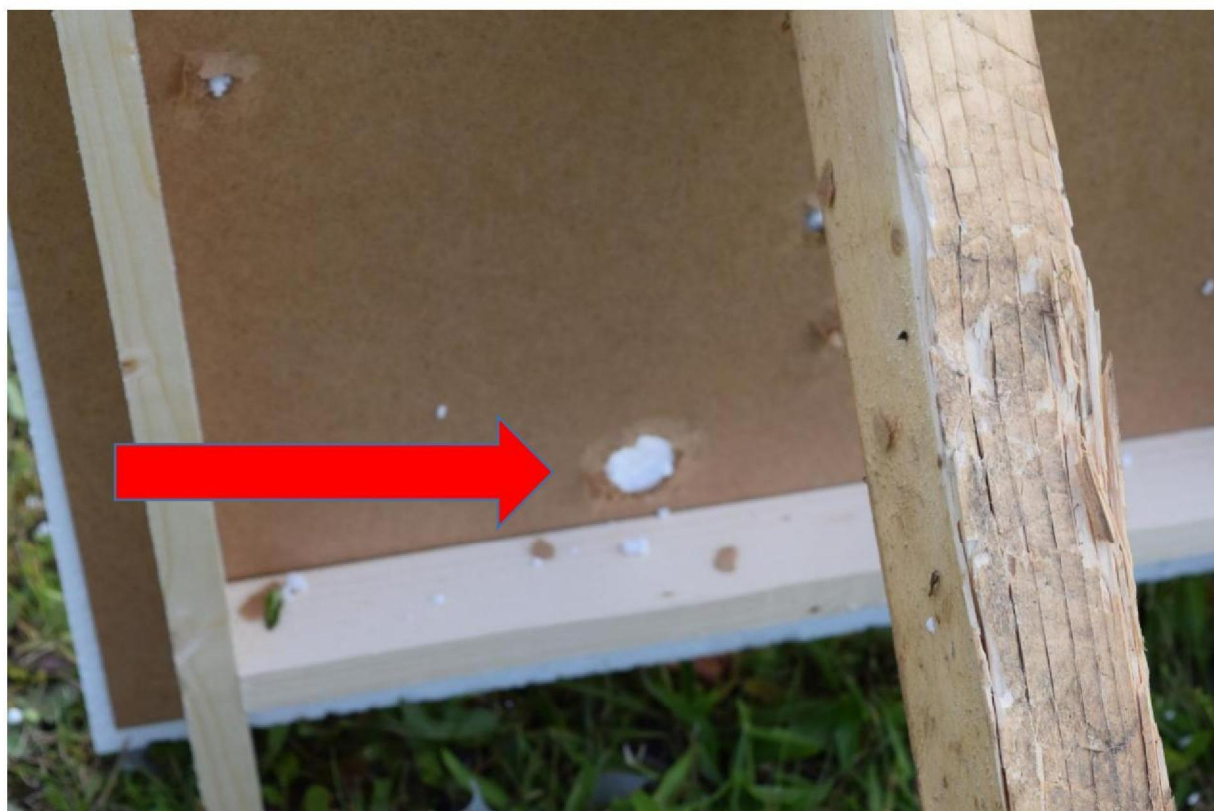
Abb. 16.2 RUBBER BATON durchschießt den Versuchsaufbau auf 10 Meter Entfernung (Rückansicht)
