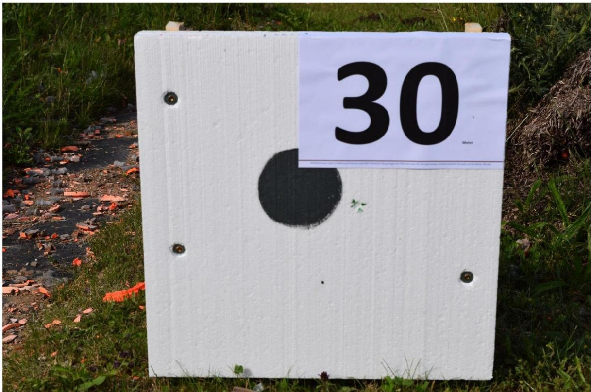
Abb. 15.6 RUBBER BUCKSHOT im 1. Durchgang; 1 Treffer von 15 auf der Scheibe
