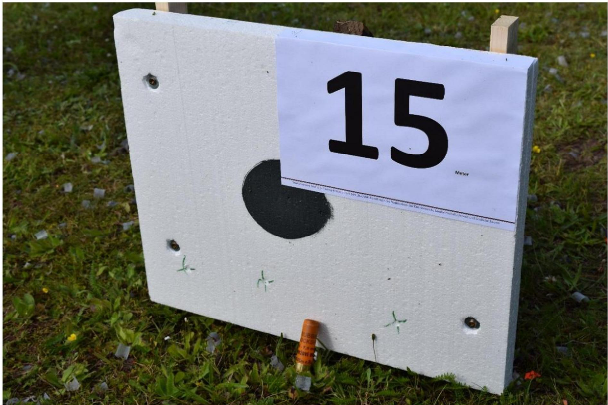
Abb. 15.3. RUBBER BUCKSHOT im 1. Durchgang; 3 Treffer von 15 auf der Scheibe. Davon haben 2 Treffer die Scheibe durchschossen
