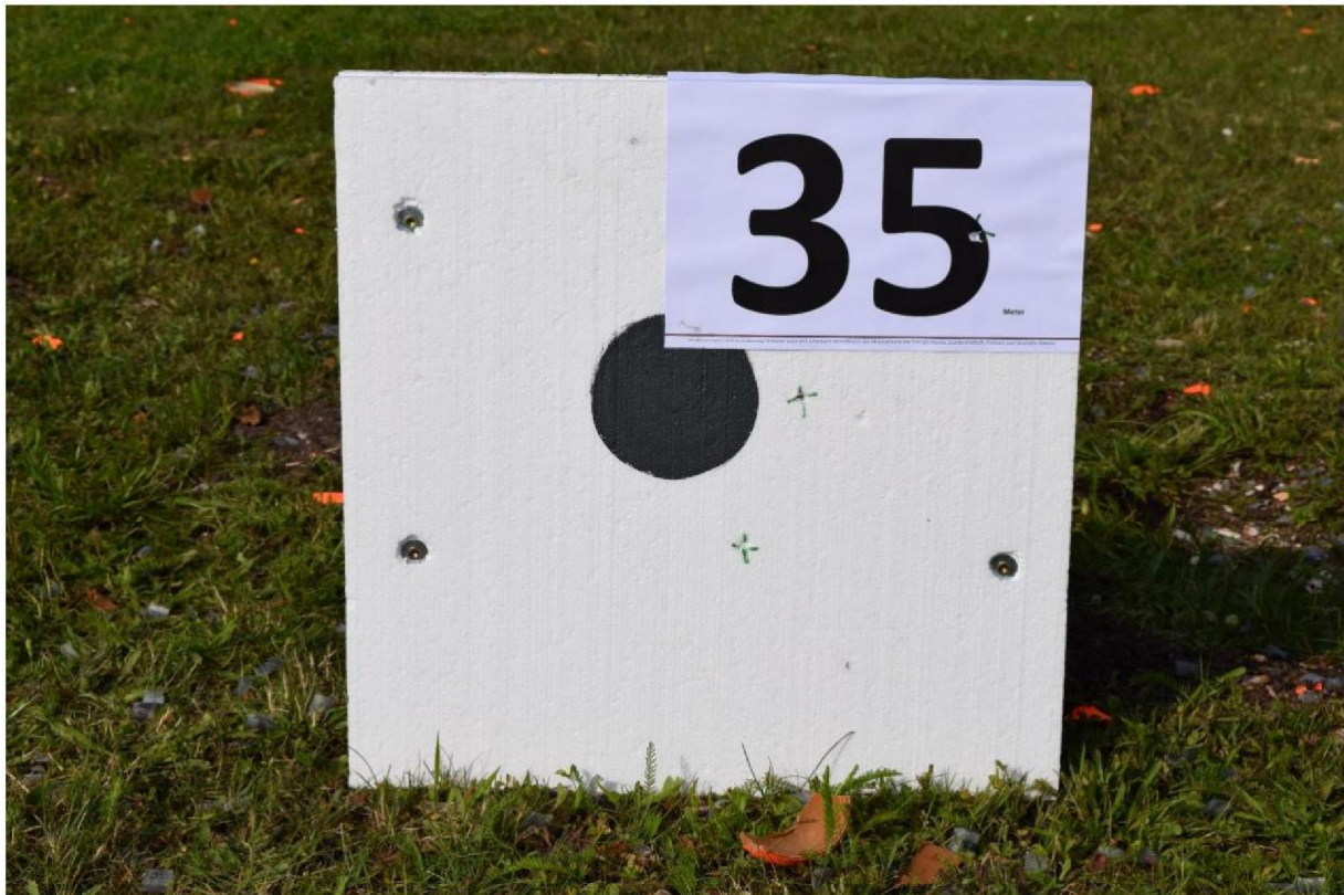
Abb. 15.7 RUBBER BUCKSHOT im 1. Durchgang; 3 Treffer von 15 auf der Scheibe, Gummischrot prallte ab und verursachte nur leichte Eintiefungen im Styropor
