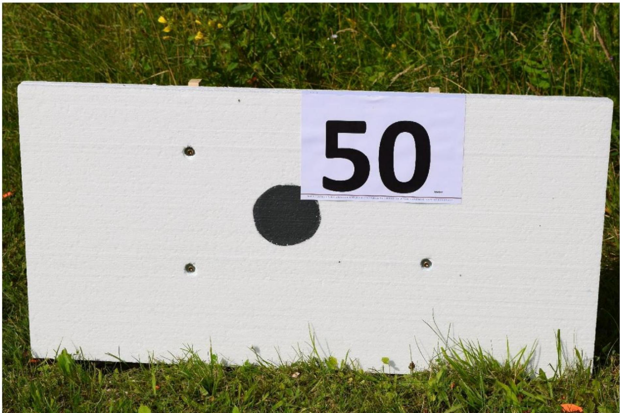
Abb. 15.10 RUBBER BUCKSHOT im 1. Durchgang; 0 Treffer von 15 auf der Scheibe
