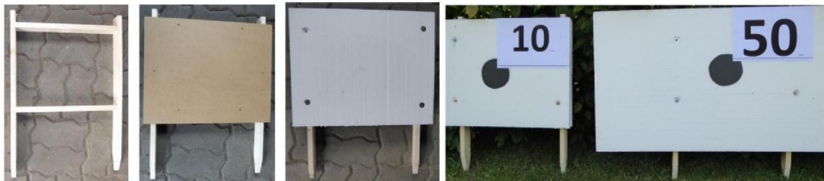
Holzrahmen: mit Hartfaserplatte mit Styroporplatte zur Kennung mit Meterangaben und Zielpunkt Abb. 17 Schrittweiser Aufbau der Zielscheiben
