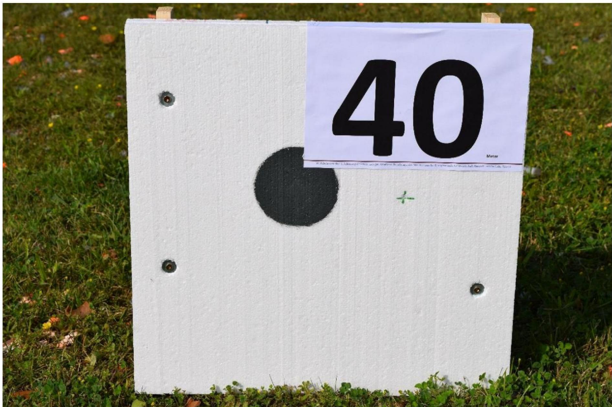
Abb. 15.8 RUBBER BUCKSHOT im 1. Durchgang; 1 Treffer von 15 auf der Scheibe, Gummischrot prallte ab und verursachte nur sehr leichte Eintiefung im Styropor
