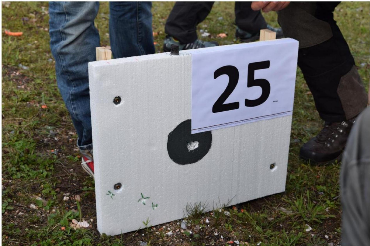
Abb. 16.5 RUBBER BATON Geschoss bleibt Versuchsaufbau auf 25 Meter Entfernung stecken (Frontansicht) – ein Schaden an der Hartfaserplatte der Rückwand war nicht feststellbar
