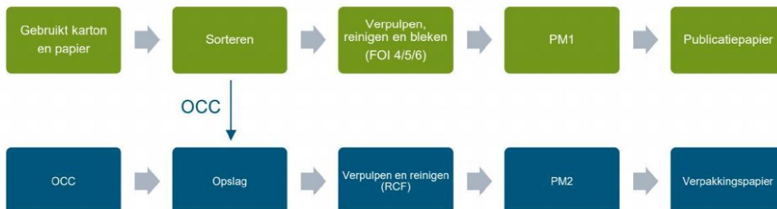
Figuur 3.1: Globaal processchema alternatief 1
