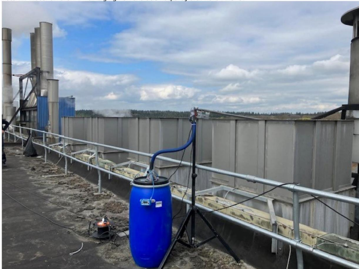
Foto 1i: Meetvlak bron 4 - afzuiging halventilatie natpartij d.d. 18-04-2023.
