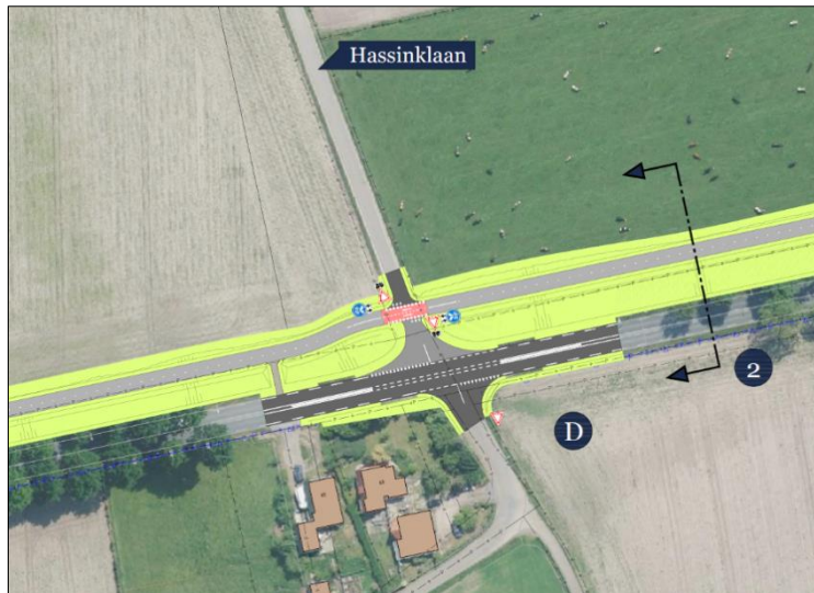
Afbeelding 5: Uitsnede uit het voorontwerp voor het wegvak Epse-Gorssel Kruising Hankweg-N348-Hassinklaan
