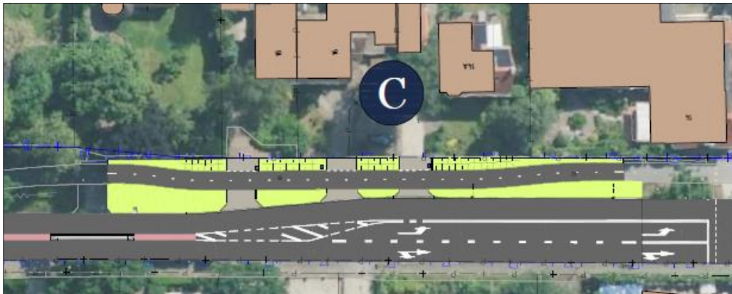
Afbeelding 10: Uitsnede uit het voorontwerp wegvak Gorssel, verschuiving fietspad ter hoogte van Deventerweg 14a, 16 en 18
