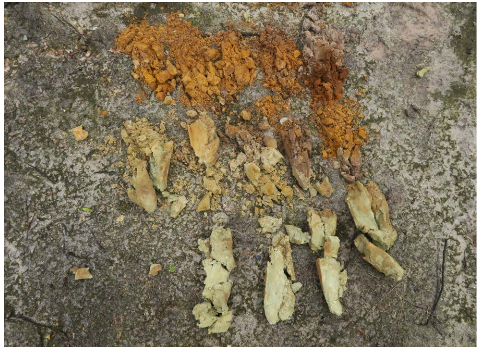
Figuur B.20 Grondboring in het heischrale grasland van Willinks Weust d.d. 17-5-2021. Het bodemprofiel toont rechtsboven een gebleekte E-horizont en daaronder (gaande naar links en naar onderen) een extreem ijzerrijke inspoelingshorizont (diep roestrood, Bg). De ijzerrijkdom neemt geleidelijk af, totdat de slecht doorlatende leem-/kleilaag is bereikt. Deze is licht van kleur, met licht rode (geoxideerde) en groenige (gereduceerde) vlekken die duiden op een hoge ijzerrijkdom. Foto: A.J.M. Jansen.
