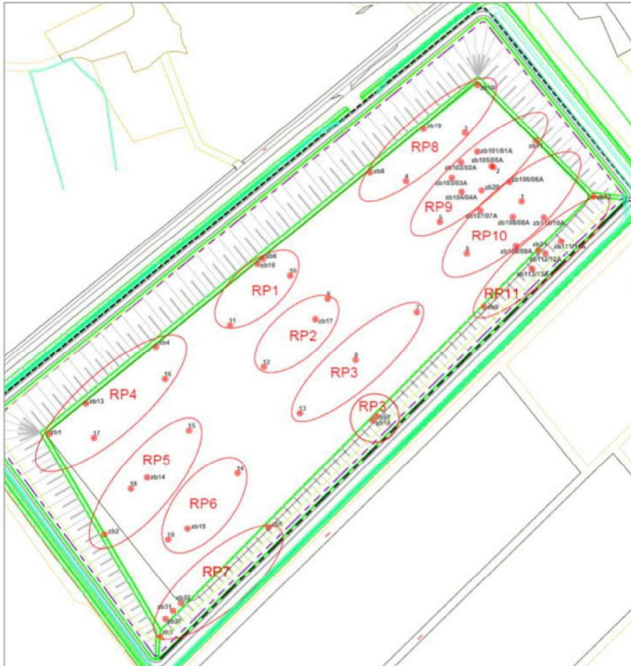
Figuur 2-6: Voormalige zakkaken (tijdens aanbrengen LD-staalslakken)
