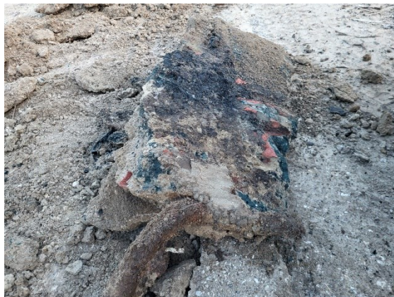
Foto 2 betongestort op asbest golfplaten
