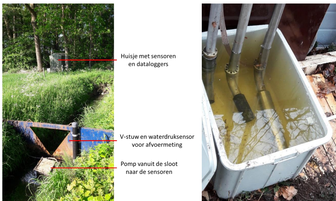
Figuur 2.7: Links de meetopstelling gezien in westelijke richting met op de voorgrond de pomp en de meetstuw en op de achtergrond het huisje met de sensoren en dataloggers; rechts de doorstroombak bij het huisje met (van links naar rechts) de bemonsteringssonde van de Phosphax, de troebelheidssensor (Solitax) en de nitraatsensor (Nitratax).
