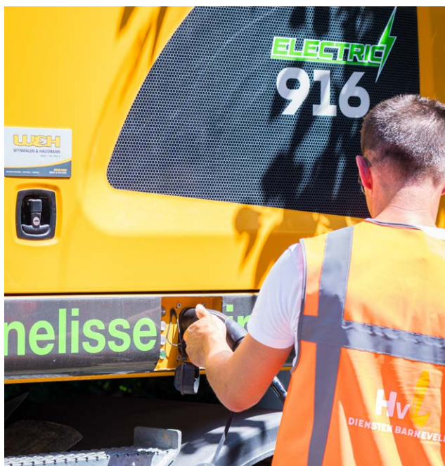
Opladen van elektrisch materieel bij project in Leiden. Bron: Sanne Edelijn, www.opwegnaarseb.nl
