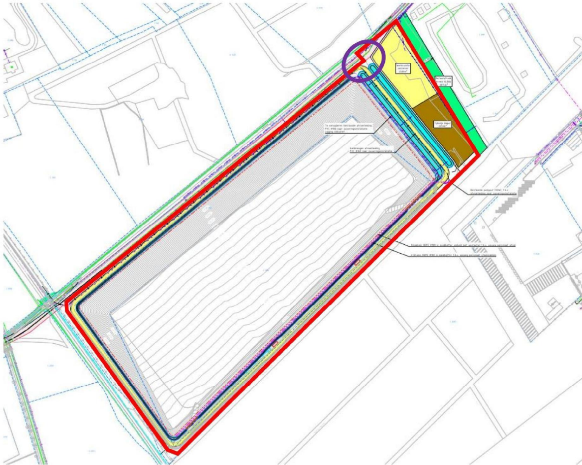
Figuur 5.8 Fase 2: het projectgebied met de tijdelijke maatregelen voor het verbeteren van de waterafvoer van de stortplaats. De plaatsing van het reptielenscherm om het projectgebied heen voorkomt dat de hazelwormen het gebied in kunnen komen tijdens de werkzaamheden.
