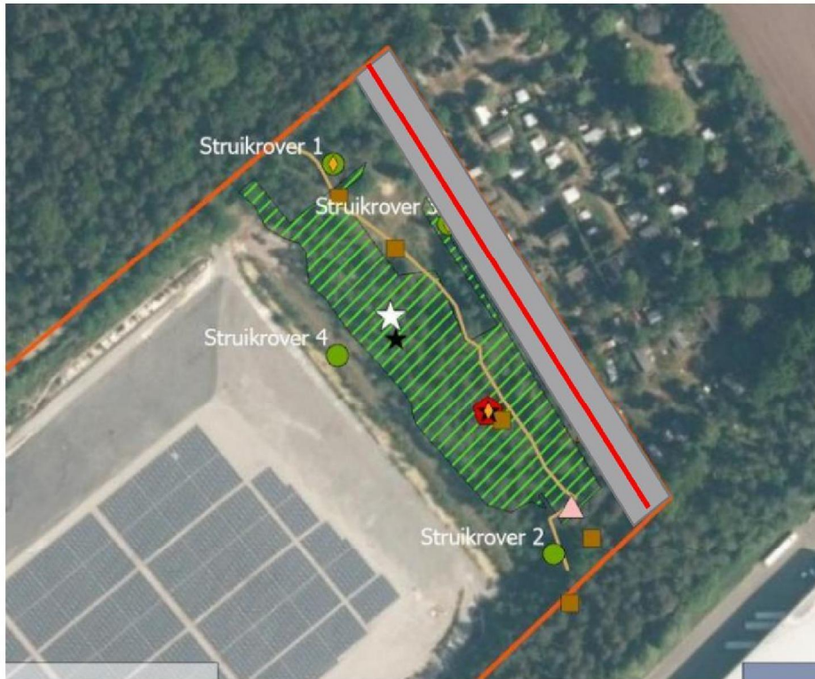
Figuur 5.1 de locatie van de nieuwe houtwal en greppel (grijze arcering) binnen het projectgebied, met de nieuwe migratieroute (rode lijn) ten opzichte van de te kappen bomen en de huidige migratieroute van das (bruine lijn). De groene arcering is globaal de locatie waar bomen gekapt gaan worden.
