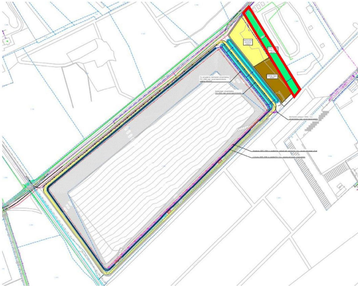
Figuur 5.7 Fase 1: reptielscherm aanleggen (rode lijn) voor de aanleg van de houtwal met greppel.
