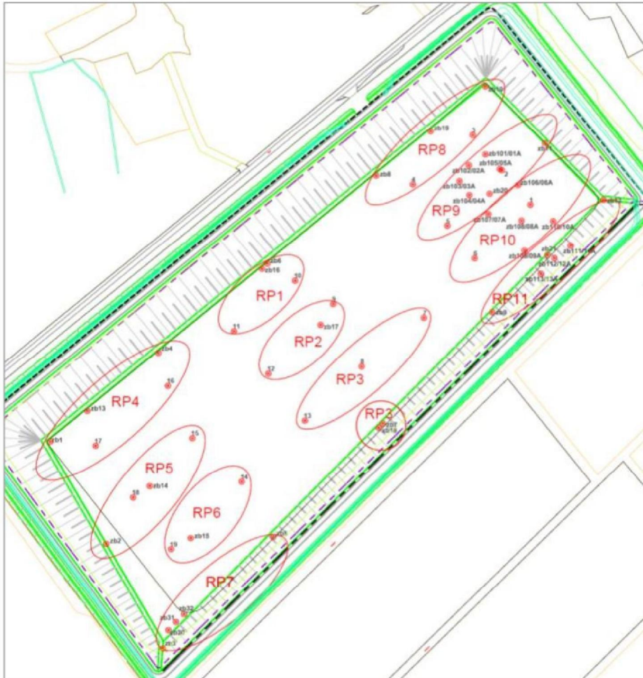
Figuur 2-6: Voormalige zakkaken (tijdens aanbrengen LD-staalslakken)
