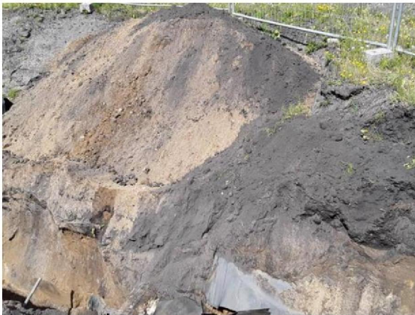
FB05: In het uitkomende zand zijn visueel geen bodemvreemde materialen aangetroffen. Derhalve is de grond rondom de constructie niet asbestverdacht.
