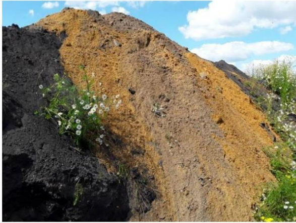
FB07: In het uitkomende zand zijn visueel geen bodemvreemde materialen aangetroffen. Derhalve is de grond rondom de constructie niet asbestverdacht.
