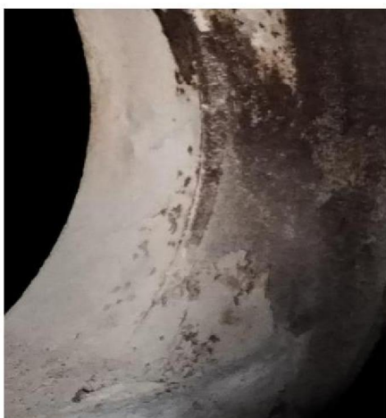
geen koordafdichting aanhechting luik op casing / constructie ronde luiken
