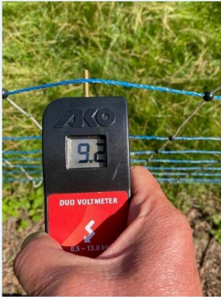
Voltage bovenste draden.jpg
