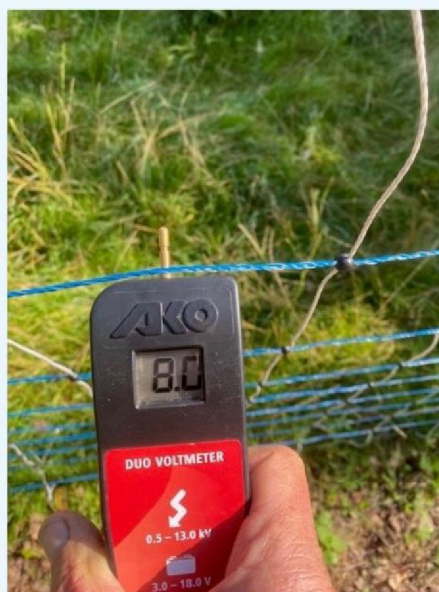
Voltage bovenste draad.jpg
