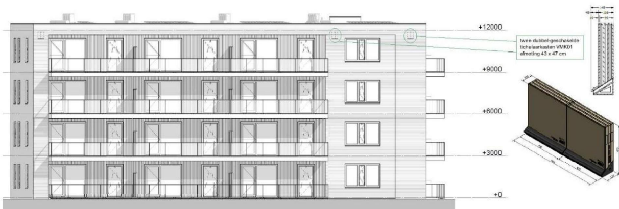
Situatietekening kleinere kraamverblijfplaatsen, in te bouwen in de noordgevel van nieuwbouw
