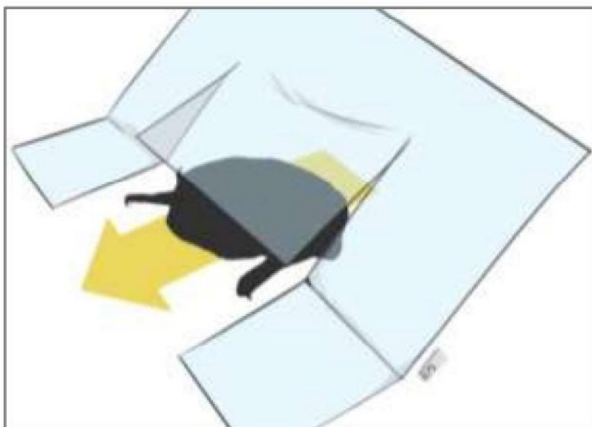
De werking van een exclusion flap. Overige openingen worden met isolatiemateriaal dichtgemaakt.
