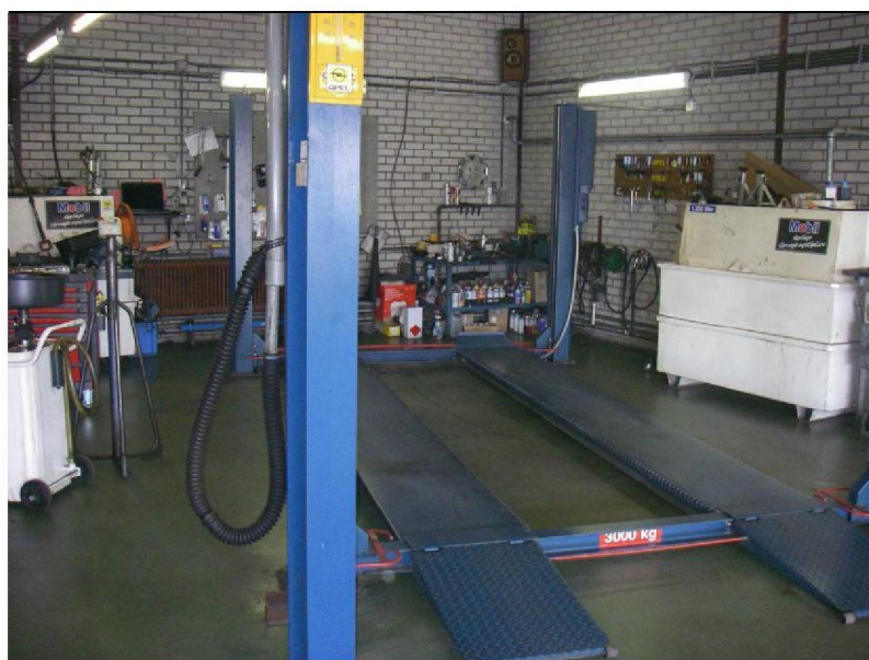
Figuur b2.2 Werkplaats met vloeistofdichte vloer
